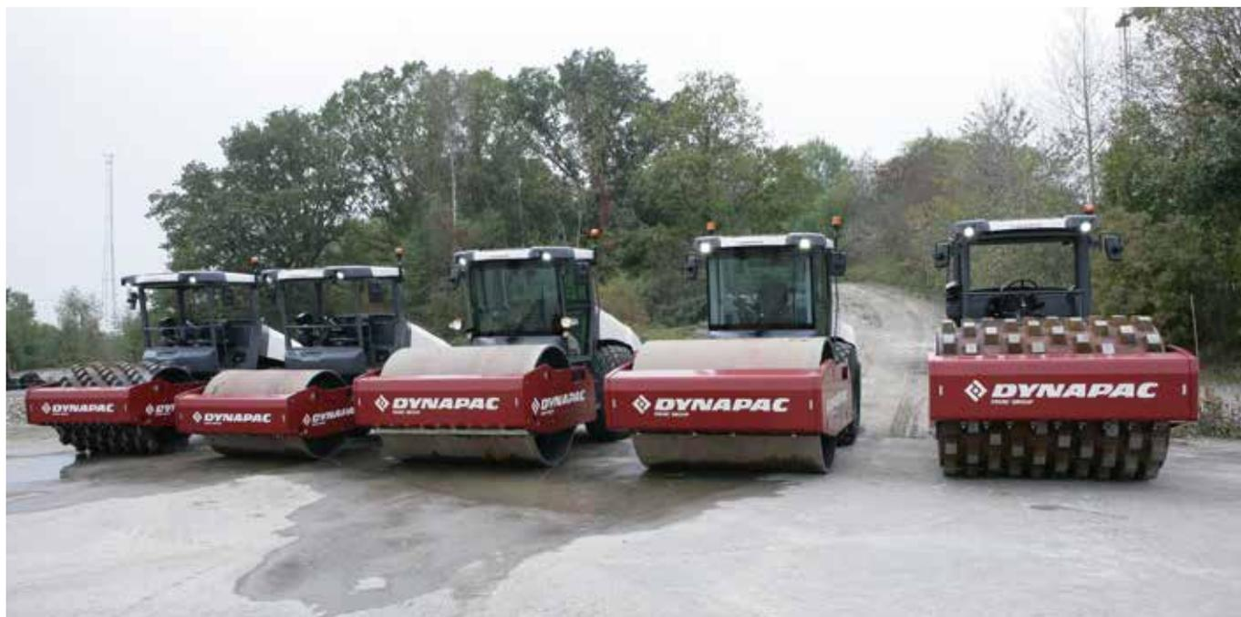
**Herramientas:** Un rodillo de tierras CA de quinta generación de Dynapac equipado con optimizador de compactación, medidor de compactación y analizador de compactación con GPS (opcional).
