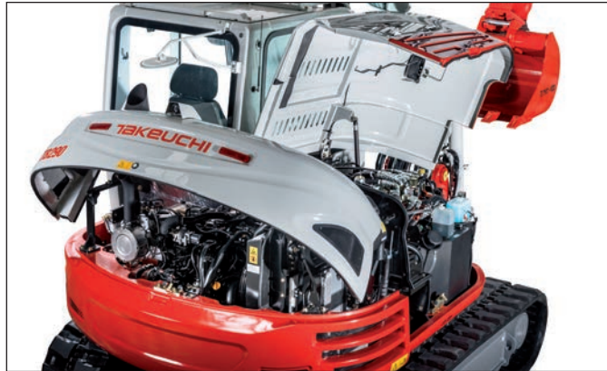
Amplias tapas abatibles para facilitar el mantenimiento y un acceso cómodo a los componentes hidráulicos y al motor.
