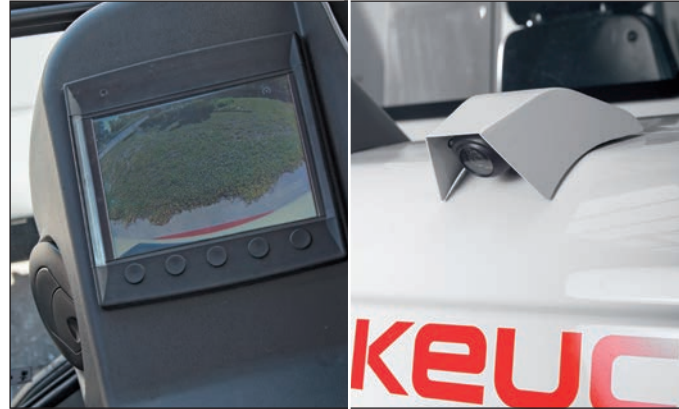
Display multifuncional, estructurado de forma clara, con visualización de la cámara de marcha atrás. Modo ECO para aumentar la rentabilidad y disminuir el consumo de gasoil.
