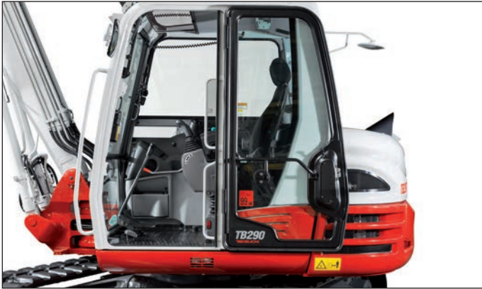
Amplia cabina insonorizada, pobre en vibraciones, con compartimentos para guardar cosas, entrada ancha con fijación masiva de puerta, cristal frontal abatible, aire acondicionado de serie.
